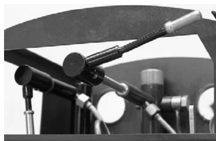
Et kig ind i førerhuset fra den åbne bagende, med mine to specialfremstillede regulatorhåndtag til henholdsvis damp og gas.
